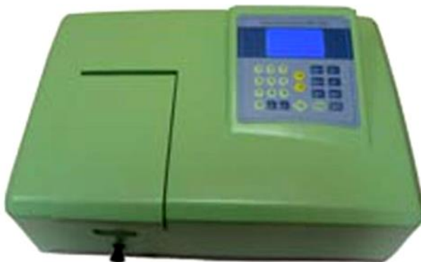
Рис.3. Фотоэлектроколориметр КФК – 3КМ.
