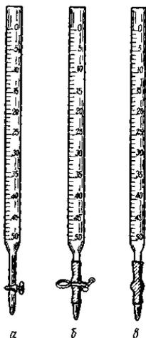
**Бюретки** - представляют собой узкие, градуированные по длине цилиндрические стеклянные трубки. Один конец бюретки сужен и снабжен стеклянным краном (а) или резиновой трубкой, соединенной с капилляром, через который из бюретки выливается раствор. Резиновая трубка зажимается снаружи металлическим зажимом (б) или закрывается изнутри стеклянным шариком (в). Обычно бюретки градуируются на миллилитры и доли миллилитра. Для отсчета объемов растворов, расходуемых на титрование, на
