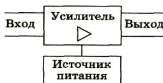
Рис.1. Функциональная схема усилителя.
