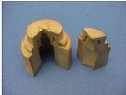
Рис. 2 Прототип полученный при лазерном спекании
