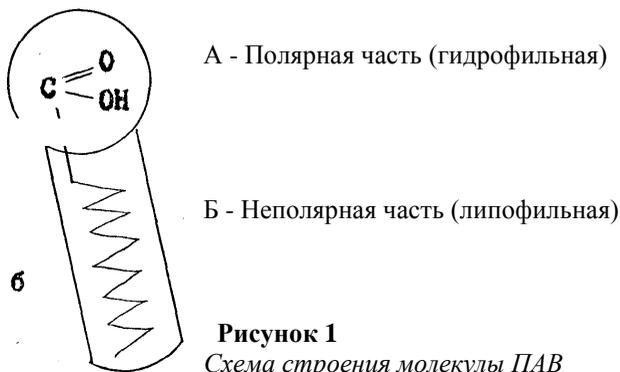
Вторая часть молекулы (Б) гидрофобная (олеофильная) образована длинной углеводородной цепью, которая и является источником поверхностной активности. Поверхностная активность тем выше, чем длиннее углеводородная цепь и чем меньше гидрофильная полярная группа.
