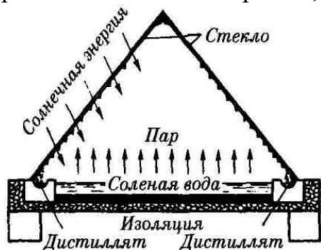
Солнечная радиация проникает сквозь покрытие, нагревает соленую воду, которая испаряется. Во внутреннем пространстве опреснителя образуется паровоздушная смесь. При соприкосновении с более холодным стеклом водяной пар конденсируется, а капли дистиллята стекают в специальные желоба-сборники. Установлено, что с каждого квадратного метра поверхности испарения ежедневно в среднем получают около 2 л опресненной воды.
