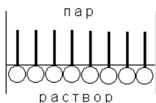
Рис. 3. Предельная ориентация молекул ПАВ в поверхностном слое
