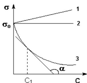
Рис.1. Изотермы поверхностного натяжения растворов ПИАВ (1,2) и ПАВ (3)
