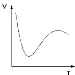
Рис. 4. Зависимость объема адсорбированного никелем водорода от температуры
