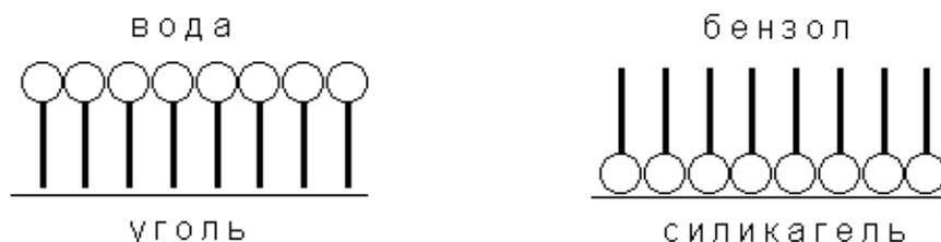
Рис. 7. Ориентация молекул ПАВ на поверхности адсорбента
