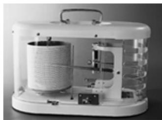
*Термограф* — самопишущий прибор для установления пределов колебаний, температуры в течение рабочего дня, суток, недели, месяцев. Воспринимающим элементом прибора является изогнутая полая металлическая пластинка, наполненная толуолом, или биметаллическая пластинка. Воспринимающий элемент связан с записывающим устройством и лентопротяжным механизмом. На ленте получается запись температуры в виде кривой. Лента разграфлена по дням, часам и градусам.
