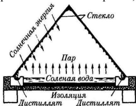
внутреннем пространстве опреснителя образуется паровоздушная смесь. При соприкосновении с более холодным стеклом водяной пар конденсируется, а капли дистиллята стекают в специальные желоба-сборники. Установлено, что с каждого квадратного метра поверхности испарения ежедневно в среднем получают около 2 л опресненной воды.
