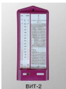
Зная показания «сухого» термометра и разность показаний «сухого» и «влажного» термометров, по психрометрической таблице определяют относительную влажность воздуха.
