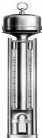
*Аспирационный психрометр Ассмана* состоит из двух ртутных термометров, заключенных в металлические трубки, через которые просасывается исследуемый воздух с помощью вентилятора. Трубки защищают резервуары термометров от лучистой энергии и обеспечивают постоянную скорость движения воздуха вокруг
