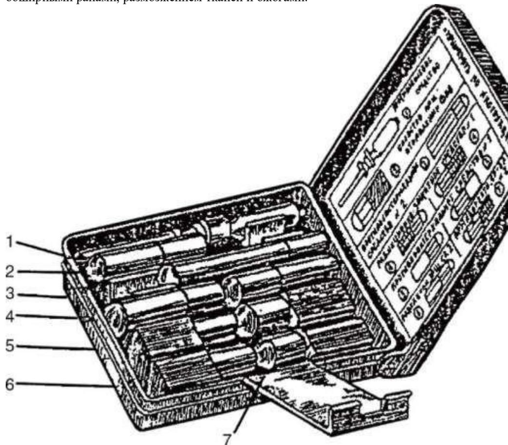
**Рис. 4.4.** Аптечка индивидуальная АИ-2: 1 - противоболевое средство; 2 - средство при отравлении фосфорорганическим отравляющим веществом; 3, 5 - противобактериальное средство; 4, 6 - радиационно-защитное средство; 7 - противорвотное средство
