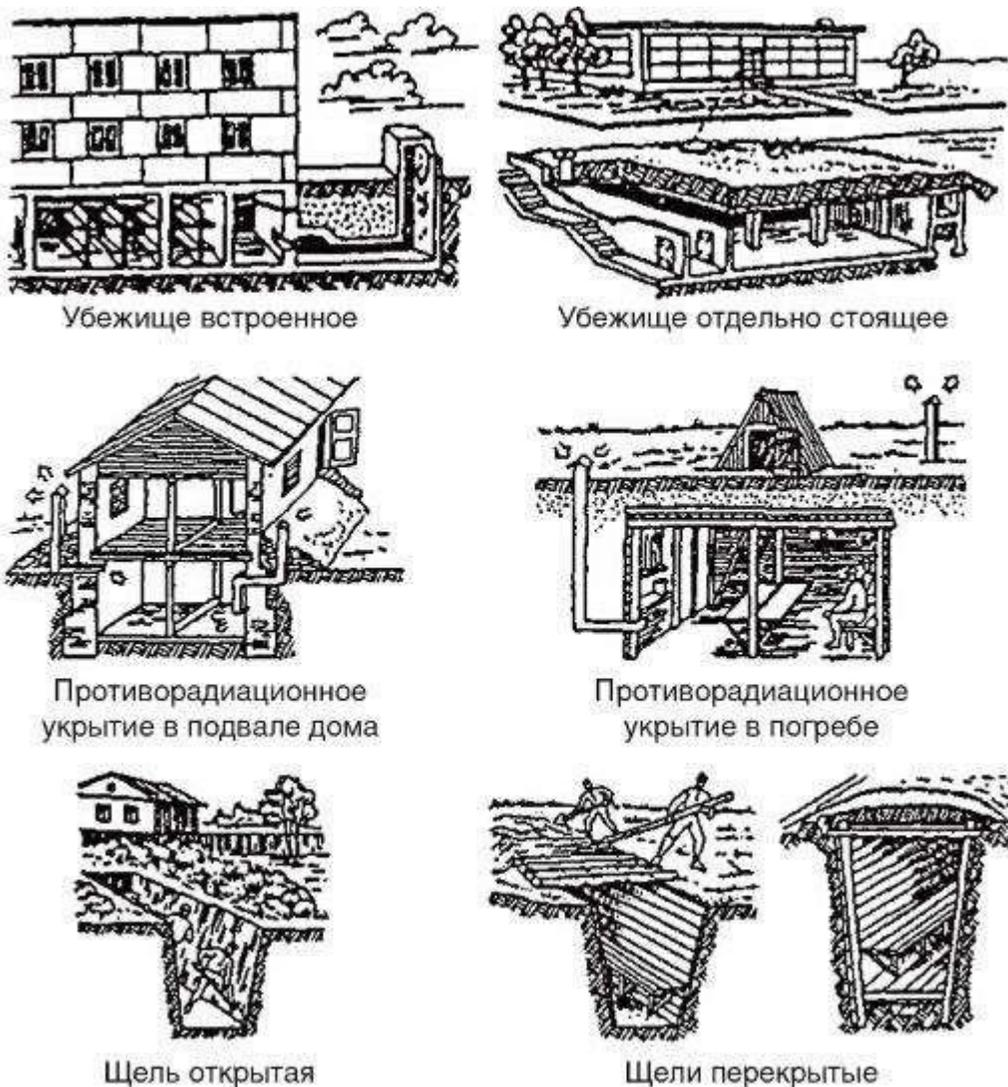
**Рис. 4.1.** Защитные сооружения
